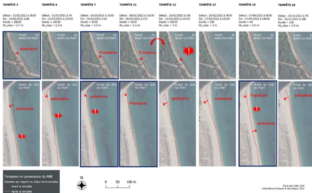
Figure 5. Mouvements du trait de côte avant et après une tempête en provenance du nord-nord-est au niveau du port de Taverna.
