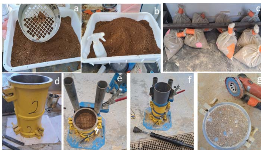
Figure 5. Préparation du sol (a-c) et fabrication d'éprouvettes de pisé (d-g).
