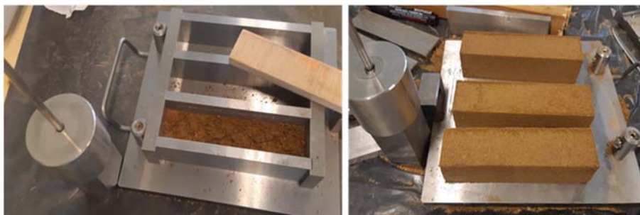
Figure 4. Fabrication de blocs de terre comprimée.
