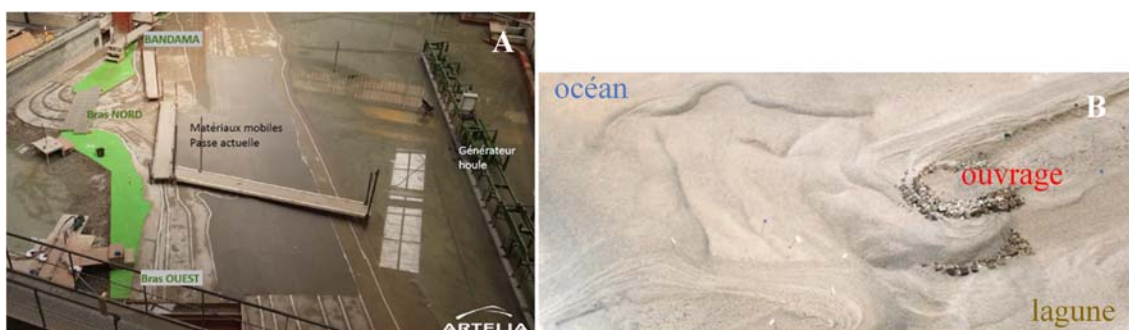
Figure 11. Vue du modèle physique (A) - Vue des fonds de la future passe et de l'ouvrage de maintien de la berge après 3 cycles annuels.
