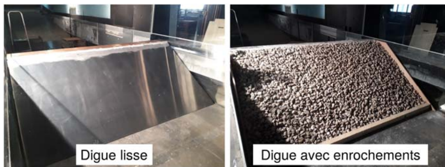
Figure 3. Photographies de la digue lisse (à gauche) et avec enrochements (à droite).
