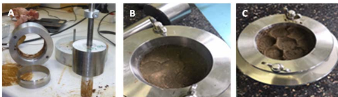
Figure 6. Proctor miniature : Appareillage et procédures avec un moule œdométrique.
