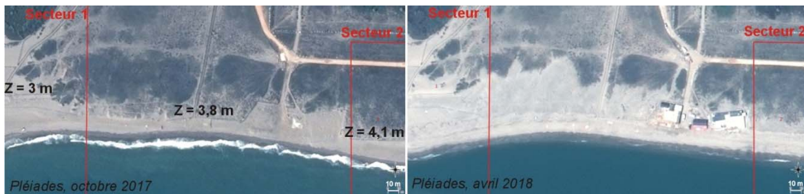
Figure 3. Illustration sur des images satellites THRS Pléiades (© CNES/Airbus/IGN) de l'ensablement généralisé de la dune fixée après la tempête du 01/03/2018 ; l'élévation initiale de la crête de dune est indiquée sur l'image de gauche.
