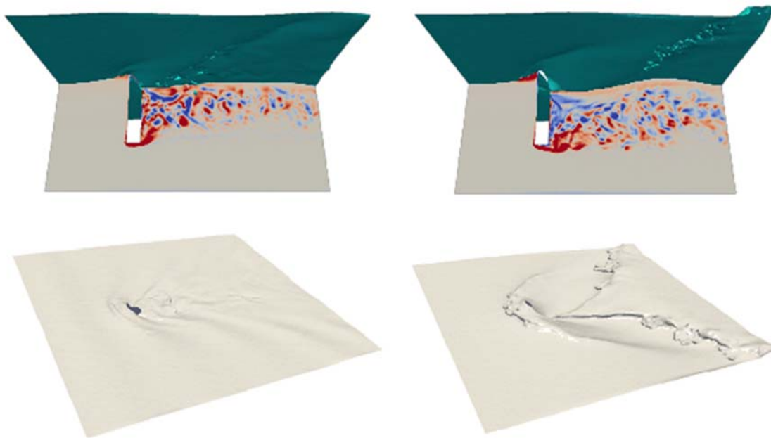
Figure 4. Vorticit  dans le plan vertical et surface libre instantan e   Ut/D = 60 . A gauche Re = 30\,000 & Fr \approx 0,86 et   droite Re = 55\,000 & Fr \approx 1,57 .
