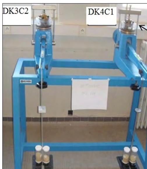
Figure 2. Appareillage œdométrique et son dispositif de chargement.
