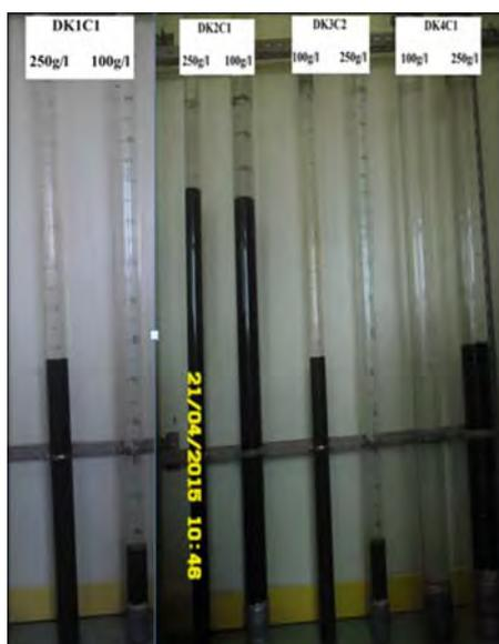
Figure 1. Colonnes de décantation.
