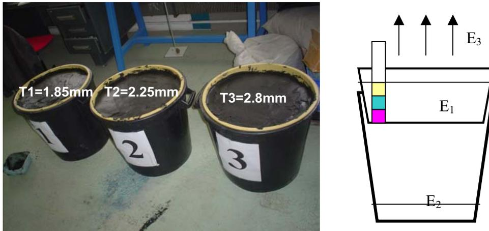
Figure 2: Schéma des essais d'égouttage
