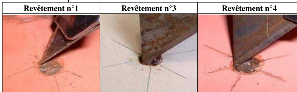
Figure 7 : Exemple de revêtement après essai de décollement cathodique
