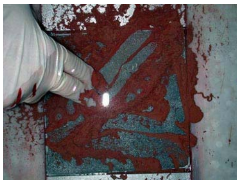
Figure 3 : L'application du revêtement n°8 est impossible
