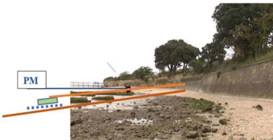
Figure 10. Même solution qu'en Méditerranée : un Rehaussement/Rechargement structuré également, mais dont le seuil aval sera conçu pour être découvert à marée basse et progressivement submergé lors du flot.
