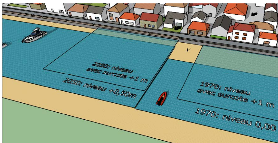
Figure 5. Vue perspective du niveau de la mer en 1970 et en 2050, sans surcote, puis avec surcote barométrique de 1 m, lors d'un évènement cyclonique.
