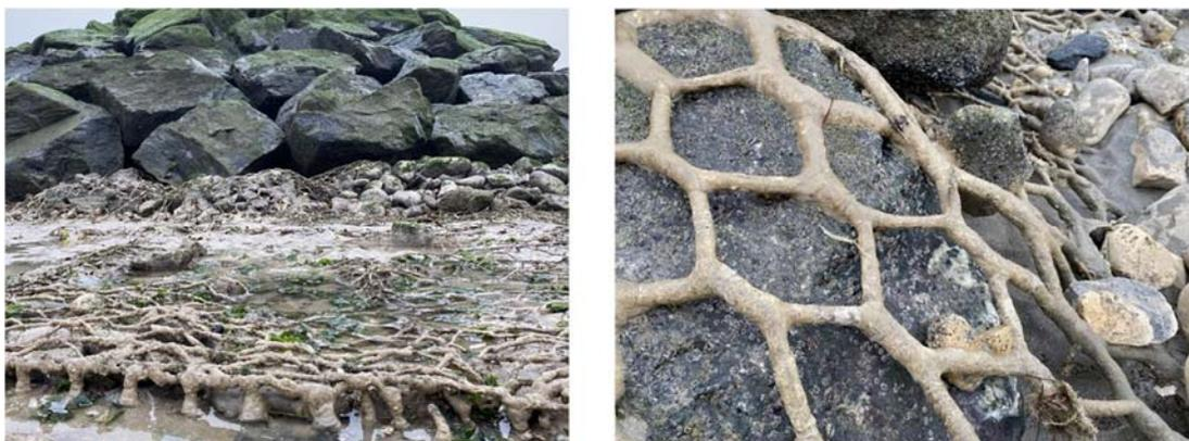
*Figure 5. Photographies des gabions après 8 mois de polarisation.*
