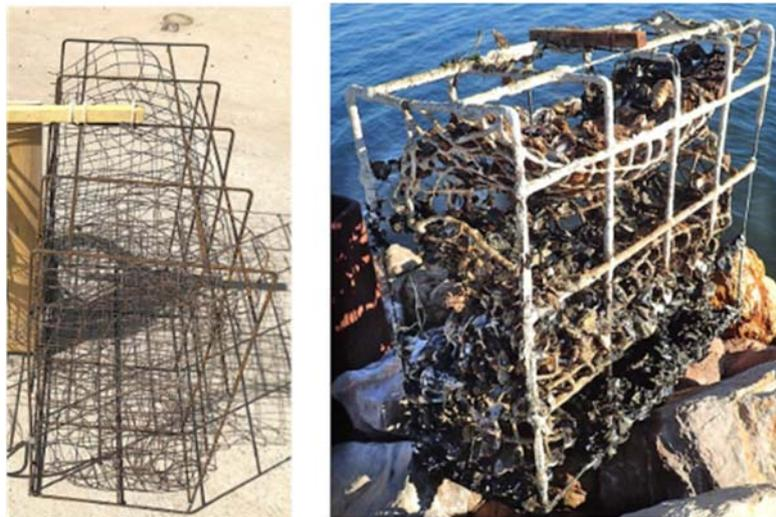
*Figure 7. (gauche) Module métallique avant polarisation. (droite) Module après 1 an de polarisation avec des déchets conchylicoles.*
