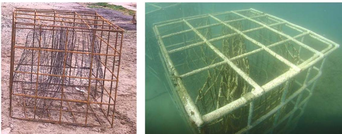
Figure 8. Exemple de module de forme cubique avant polarisation (gauche) et en cours de polarisation après 6 mois (droite).
