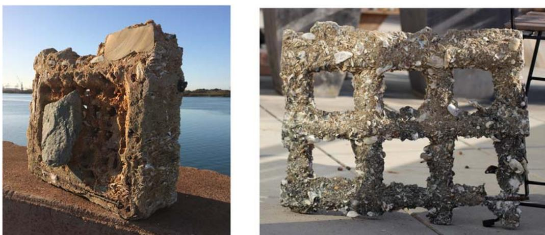
Figure 1. Prises de vues d'échantillons de Geocorail obtenus dans des sédiments de natures différentes.
