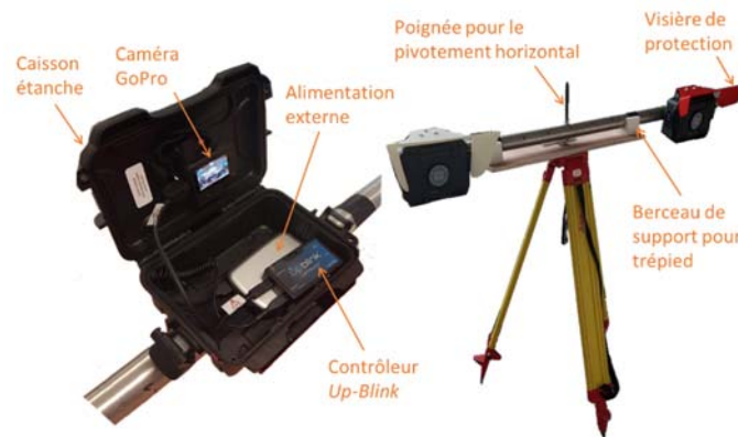
Figure 1. Système de mesure stéréo-vidéo conçu pour cette étude, composé de deux caméras GoPro TM montées sur une barre rigide (baseline) ajustable sur différents systèmes de fixation (ex. trépied).
