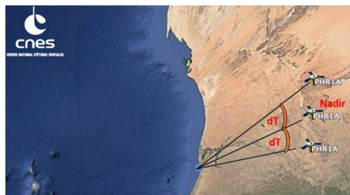
Figure 2. Clichés satellites utilisés pour la reconstruction topographique par stéréogrammétrie.
