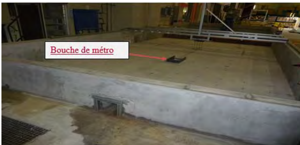
Figure 3. Modèle physique de la bouche de métro étudiée.
