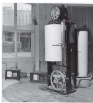
b- De gauche à droite : marégraphes OTT 3068 et OTT R16 (1949-1992)
